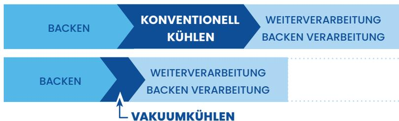
Der benötigte Dampf kommt aus dem Brot. Unter Vakuum wird der Druck verringert (die Feuchtigkeit im Brot muss schließlich kochen – und das passiert auch). Die hierzu notwendige Energie wird dem Brot entzogen. Dadurch wird das Brot „kalt gebacken“!
